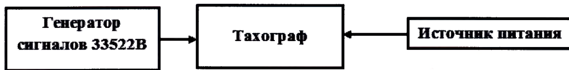
Рисунок 3 – Схема проведения измерений при определении инструментальной погрешности измерения скорости по датчику движения
